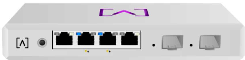
**Pulsante di reset** Per ripristinare le impostazioni di fabbrica del router, mantenere premuto il pulsante di reset per 10 secondi fino a quando il LED inizia a lampeggiare.
