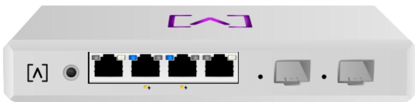
**Reset-Taste** – Drücken Sie die Taste 10 Sekunden lang, bis die LED zu blinken beginnt, um den Router auf die Werkseinstellungen zurückzusetzen.
