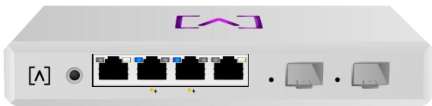
**Bouton de réinitialisation.** Appuyez sur le bouton pendant 10 secondes jusqu'à ce que la LED se mette à clignoter pour réinitialiser le routeur à ses valeurs d'usine.
