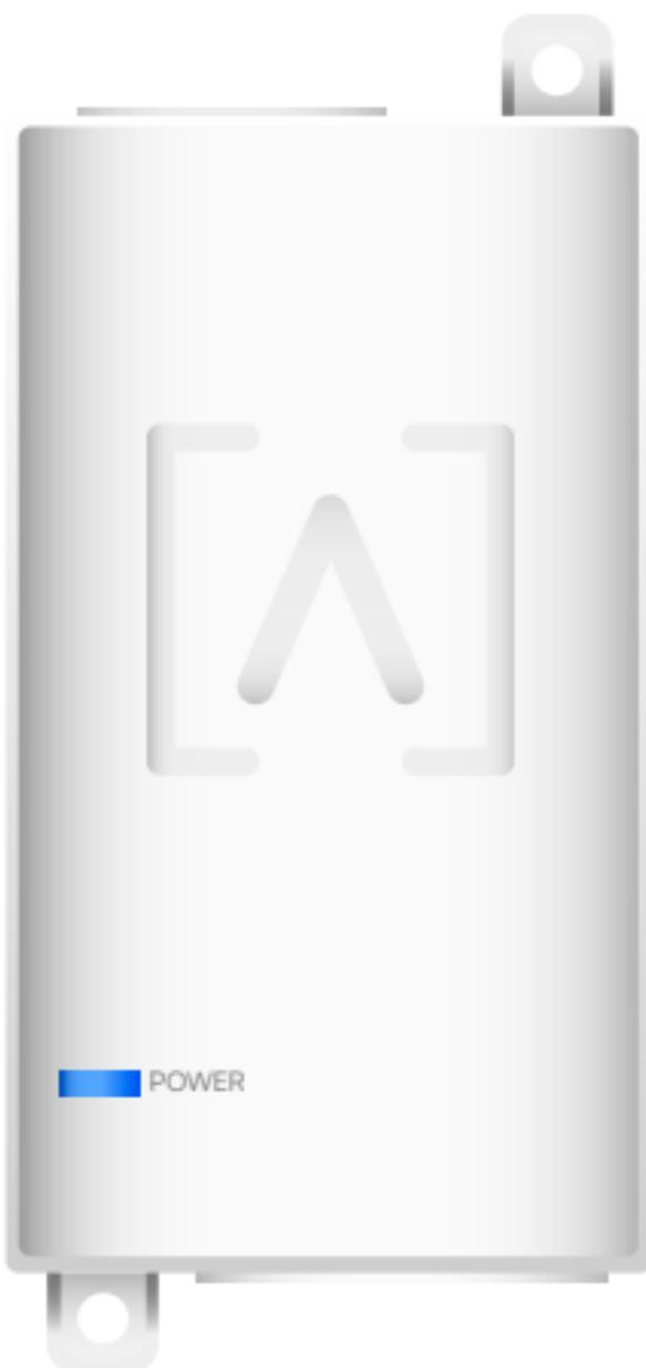
**LED POWER** Il LED si illumina in bianco quando l'Injector-POE+ è correttamente collegato ad una sorgente di alimentazione.
