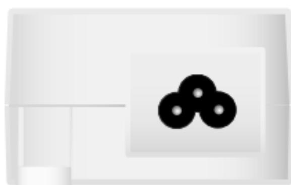
**ALIMENTATION :** Ce port est prévu pour y brancher le cordon d'alimentation. L'autre côté doit être branché à une source d'alimentation telle qu'une prise murale ou une multiprise.
