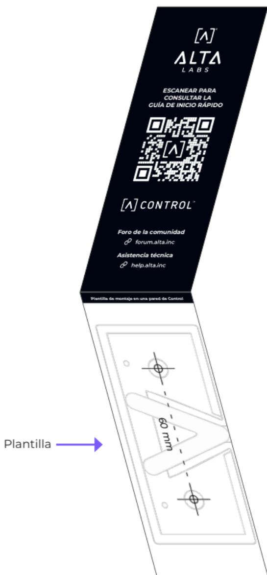
2. Coloque la plantilla en la posición deseada y utilice un lápiz para marcar los orificios.
