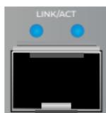
Los puertos SFP+ admiten transceptores de fibra óptica y Ethernet con conexiones de 1 Gbps, 2.5 Gbps, 5 Gbps o 10 Gbps.
