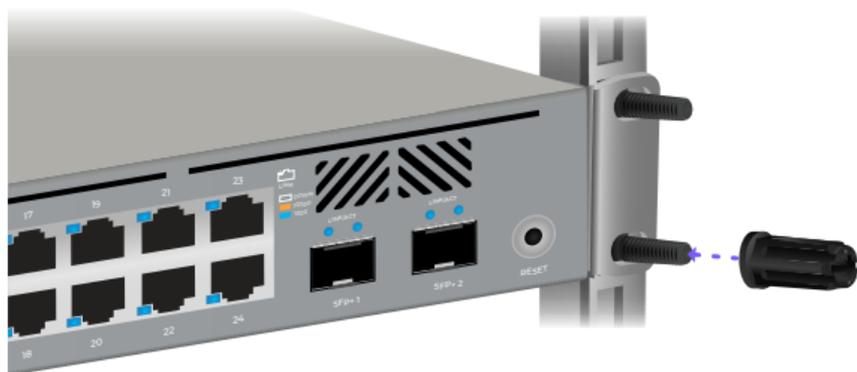
7. Coloque las tuercas Rackstud DUO superiores a ambos lados del conmutador.
