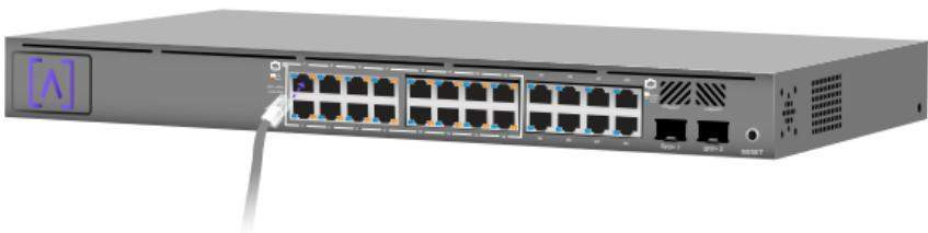
2. Urmați instrucțiunile incluse cu dispozitivele de emisie-recepție, pentru a le conecta la porturile SFP+. Dacă nu folosiți porturile, vă rugăm să le astupați cu dopurile SFP+.
