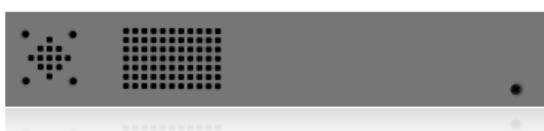
Panourile laterale sunt prevăzute cu orificii de ventilare.
