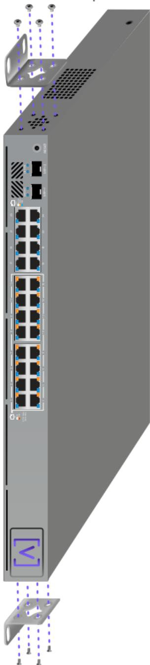
2. Folosiți șuruburi de perete și dibruri (nu sunt incluse), pentru a fixa ambele laturi ale switch-ului de perete.
