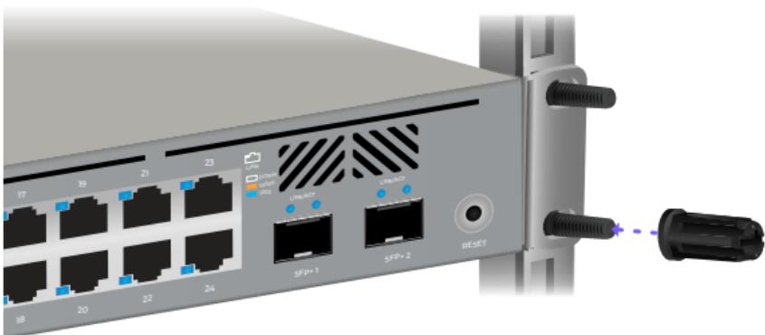
7. Conectați piulițele Rackstud DUO de sus, pe ambele laturi ale switch-ului.
