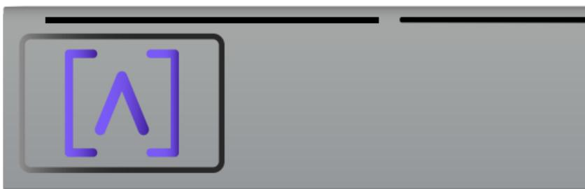
Ledul Alta Labs luminează intermitent la pornirea unității. Odată pornirea finalizată, ledul va rămâne aprins cu excepția cazului în care este oprit din interfața cu utilizatorul. și culoarea ledului poate fi schimbată din interfața de gestionare.
