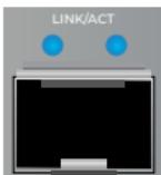
Porturile SFP+ acceptă dispozitivele de emisie-recepție cu fibră optică și Ethernet cu conexiuni de 1 Gbps, 2,5 Gbps, 5 Gbps sau 10 Gbps.
