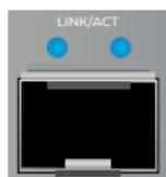
As portas SFP+ suportam transceptores de fibra óptica e Ethernet com conexões de 1 Gbps, 2,5 Gbps, 5 Gbps ou 10 Gbps.
