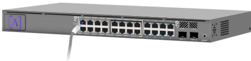
2. Ακολουθήστε τις οδηγίες των πομποδεκτών για σύνδεση στις θύρες SFP+. Αν δεν χρησιμοποιείτε τις θύρες, καλύψτε τις με βύσματα θύρας SFP+.
