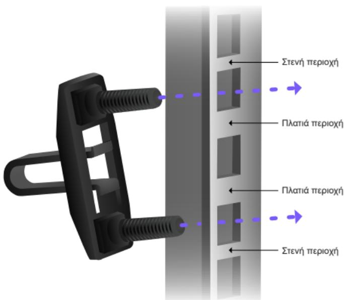
4. Πιέστε το ελατήριο και περάστε το στήριγμα Rackstud DUO πίσω από τη ράγα.
