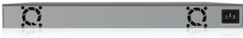
Die Belüftungsöffnungen befinden sich auf der Rückseite des Switches. Stellen Sie sicher, dass Sie das mitgelieferte Netzkabel für den Stromanschluss verwenden.
