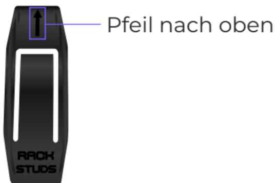
3. Setzen Sie den Rackstud DUO-Bolzen am Anfang des RU-Bereichs direkt unterhalb des schmalen Bereichs ein.
