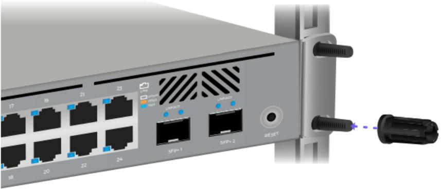
7. Verbinden Sie die oberen Rackstud DUO-Muttern auf beiden Seiten des Switches.
