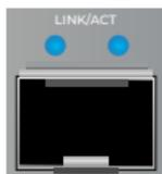
Die SFP+-Ports unterstützen Glasfaser- und Ethernet-Transceiver mit Verbindungen von 1 Gbit/s, 2,5 Gbit/s, 5 Gbit/s oder 10 Gbit/s.
