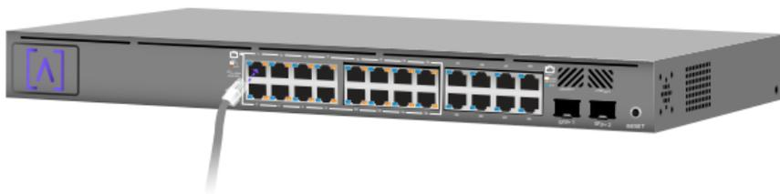
2. Suivez les instructions accompagnant vos émetteurs-récepteurs pour les connecter aux ports SFP+. Si vous n'utilisez pas les ports, n'oubliez pas d'installer les bouchons pour ports SFP+ sur lesdits ports.
