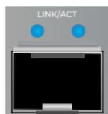
Les ports SFP+ sont compatibles fibre optique et émetteurs-récepteurs avec connexion à 1 Gbps, 2,5 Gbps, 5 Gbps ou 10 Gbps.
