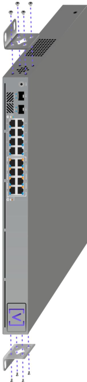
2. Använd skruvar och plugg avsedda för väggmontering (medföljer inte) på båda sidor om switchen.
