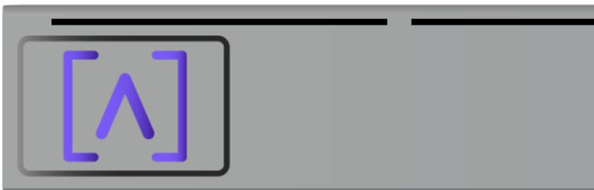
Alta Labs LED-lamporna blinkar när enheten startar. Efter start fortsätter LED-lamporna att vara tända såvida du inte stänger av dem i användargränssnittet. Du kan även ändra färgen på dessa i användargränssnittet.
