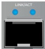
SFP-portarna har stöd för fiberoptik och Ethernet-sändtagare med anslutningar på 1 Gbit/s.
