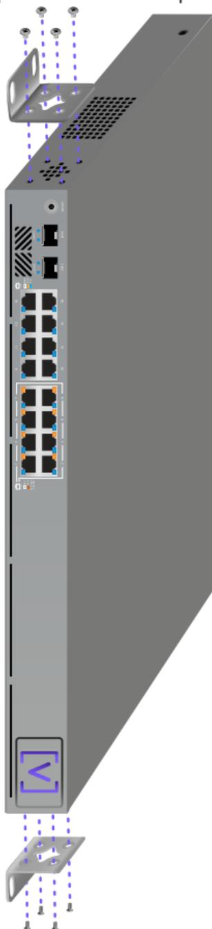
2. Use parafusos de parede e buchas (não incluídos) para fixar ambos os lados do switch na parede.
