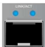
As portas SFP suportam transceptores de fibra óptica e Ethernet com conexões de 1 Gbps.
