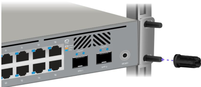
7. Conecte as porcas Rackstud DUO superiores em ambos os lados do switch.
