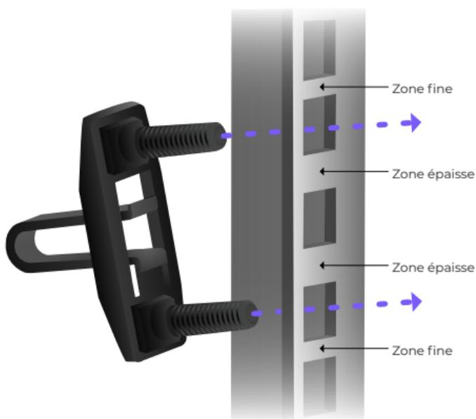
4. Comprimez le ressort et insérez le support Rackstud DUO depuis l'arrière du rail.
