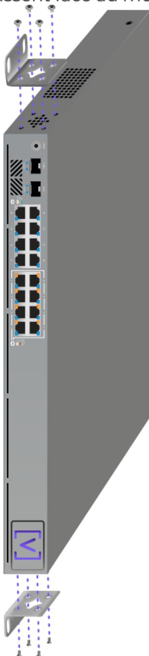
2. Utilisez des vis murales et des chevilles (non fournies) pour sécuriser les deux côtés du switch au mur.
