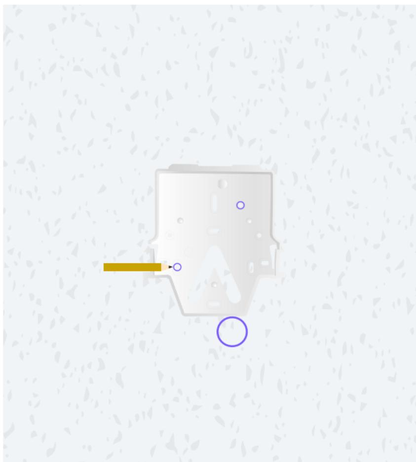
3. Fije la placa de montaje al soporte para techo con el panel de techo entre medio. Use los dos tornillos para paneles de techo y las dos tuercas.
