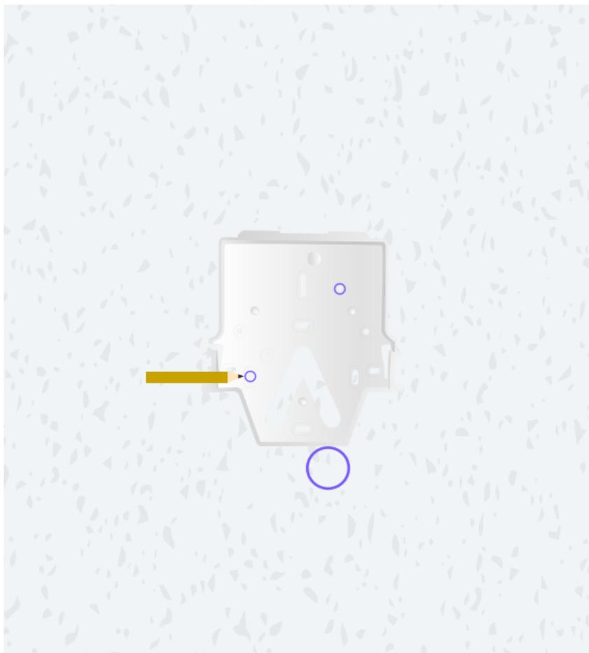
3. Prenda a placa de montagem ao suporte de teto com a placa de teto usando os dois parafusos de placa de teto e as duas porcas.
