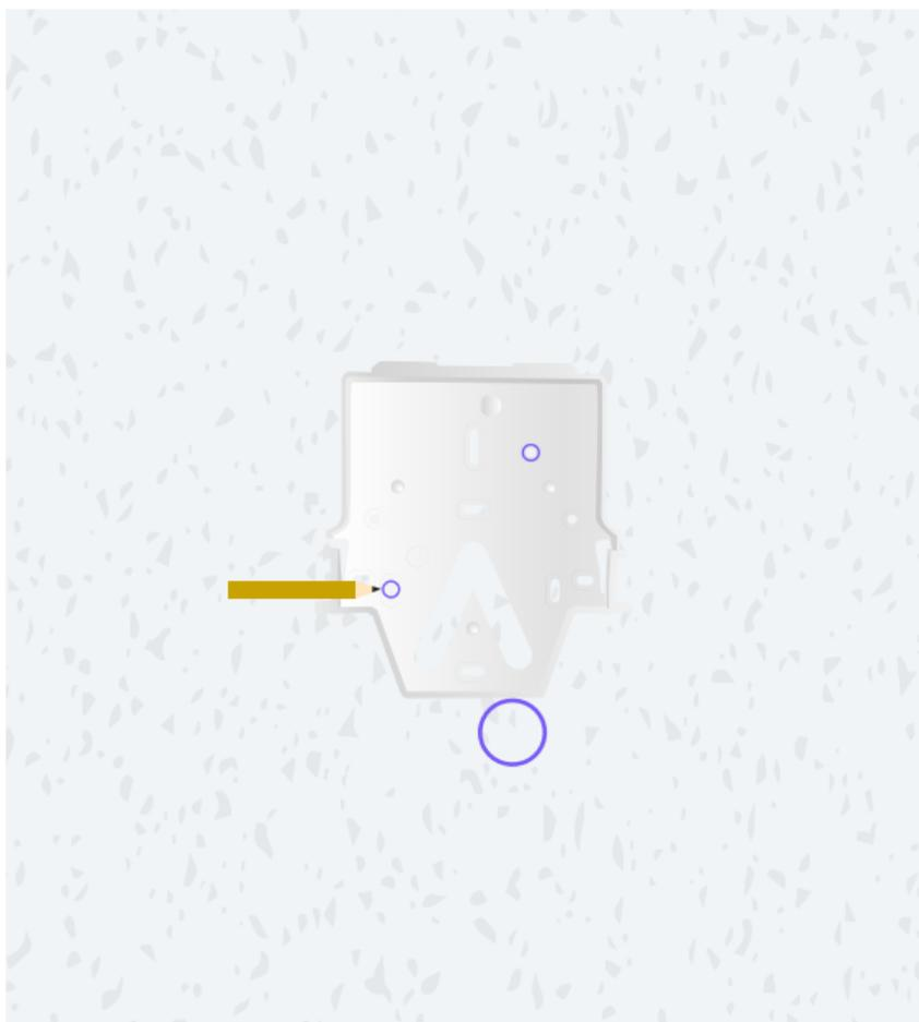
3. Fissare la piastra di montaggio al pannello del controsoffitto utilizzando le due viti per montaggio su controsoffitto e i due relativi dadi.
